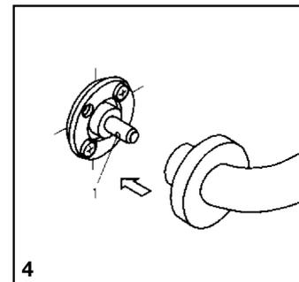
Verstiftungslöcher (1) der Bolzen ausrichten. Halter mit aufgeschobenen Rosettenkappen fest aufdrücken.
