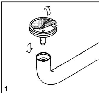
**(D)** Rosettenunterteile in Halterenden einsetzen und Schutzpapiere abziehen.
