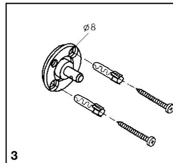
Dübellöcher 8 mm  $\varnothing$  durch Rosettenunterteile bohren. Unterteile festschrauben.
